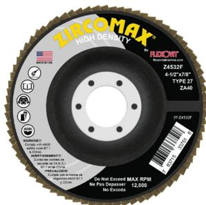
Los **DISCOS DE LAMINADOS DE ALTA DENSIDAD TIPO 27 Y TIPO 29 ZIRCOMAX Flexovit** están hechos con una capa extra gruesa de tela abrasiva de zirconio de alta calidad que utiliza un respaldo de fibra de vidrio de alta resistencia como soporte.
