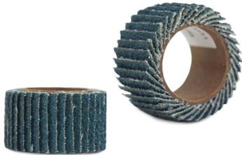
Las **BANDAS FLAP Flexovit HIGH PERFORMANCE** son herramientas excepcionales para la remoción agresiva de material en lugares de difícil acceso. Perfectas para desbastar y dar acabado en el diámetro interior de tuberías o cañerías. Las bandas flap de zirconio son una alternativa duradera de alto rendimiento a los discos laminados y bandas en espiral. Las bandas flap deben montarse en tambores de expansión de caucho de tamaño compatible.
