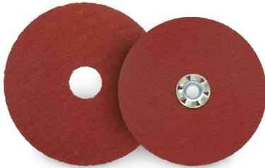
Los **DISCOS DE LIJA CERÁMICOS Flexovit SANDSTORM CG Y CG PLUS** incorporan granos de cerámica estándar y avanzados con una capa superior de aditivos. Todo sobre un respaldo de fibra vulcanizada de alta resistencia. Esta combinación de grano abrasivo duradero y agentes refrigerantes reduce la fricción y maximiza la vida útil del disco.
