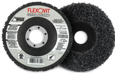
Los **DISCOS PARA LIMPIEZA Flexovit HIGH PERFORMANCE** están hechos de una red abierta de filamentos de nylon continuos y fuertes a los que se adhiere el grano abrasivo de carburo de silicio grueso. La combinación de un respaldo suave y abierto con un abrasivo extremadamente agresivo hace que estos discos sean ultra eficientes para eliminar los materiales resistentes que quedan en la superficie de trabajo sin alterar excesivamente su forma.
