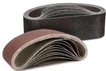
Las **BANDAS DE LIJA INDUSTRIALES Y PORTÁTILES Flexovit HIGH PERFORMANCE** cuentan con respaldo de tela de algodón de peso "x" con unión de polietilentereftalato al ras. Resiste al estiramiento y asegura un lijado suave y sin golpes. El grano de óxido de aluminio de primera calidad y el enlace total resinoso mantienen la banda flexible aún a altas temperaturas.
