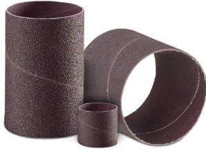
Los **CASQUILLOS DE LIJA ESPIRAL Flexovit HIGH PERFORMANCE** están diseñadas para aplicaciones de acabado, especialmente en curvas y contornos. Elimina fácilmente las rayas y las líneas de separación. Grano de óxido de aluminio de calidad, sujeto con resina a un soporte extra resistente. Los casquillos deben montarse en tambores de caucho de tamaño compatible.
