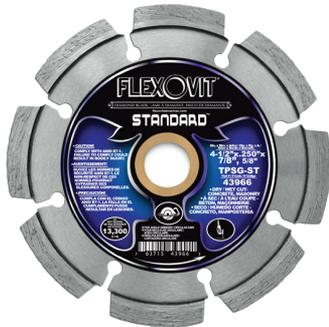
Las **LOS DISCOS SEGMENTADOS Flexovit STANDARD** son para aplicaciones de trabajo en seco o húmedo en esmeriladoras angulares y sierras circulares. Son ideales para la remoción de lechada y mortero entre ladrillos y bloques.
